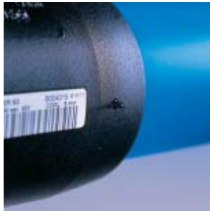
Fig. 66 Bij gelaste elektrolassmoffen zijn aan ieder buiseinde de indicatienippels omhoog gekomen.
