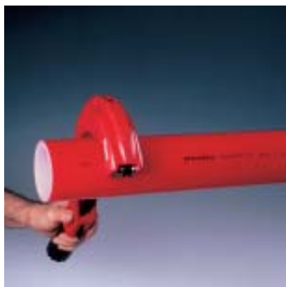
Fig. 15 1. Buis op de gewenste lengte inkorten.
