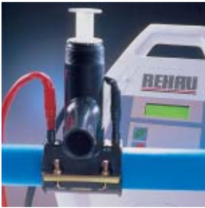
Fig. 46 7. Er klinkt een geluidssignaal na afloop van de lasprocedure. De stekkers kunnen worden losgemaakt.
