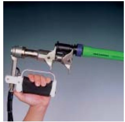
Fig. 9 3. Buis tweemaal 30° verdraaid met expanderbit...
