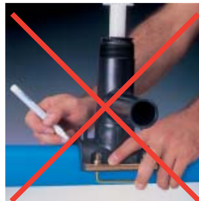
Fig. 55 Bovenste deel boorklem niet gebruiken voor het aftekenen.
