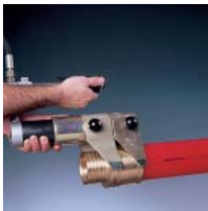
Fig. 22 8. Pershuls tot aan de kraag van de fitting schuiven.
