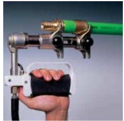
Fig. 12 6. Gereedschap op de verbinding plaatsen. Niet schuin houden.
