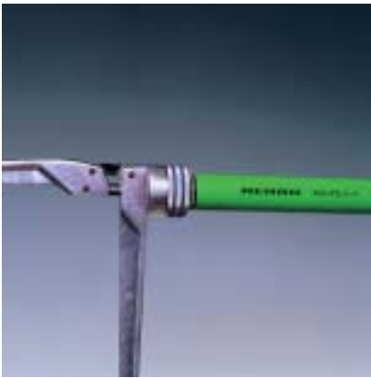
Fig. 10 4. ...of met expanderbit expanderen
