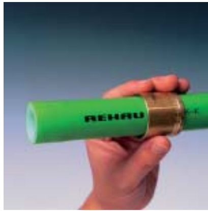
Fig. 8 2. Pershuls over de buis schuiven. De inwendige afschuining moet naar het uiteinde van de buis wijzen.
