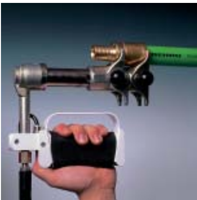
Fig. 13 7. Pershuls tot aan de kraag van de fitting schuiven.
