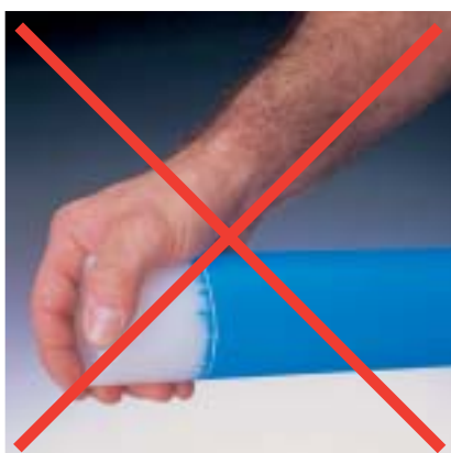
Fig. 59 Laszone niet aanraken.
