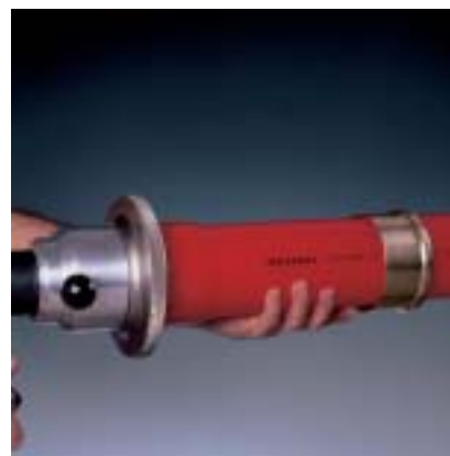
Fig. 17 3. Buis tweemaal 30° verdraaid met de expandeereenheid van RAUTOOLS G1 expanderen.
