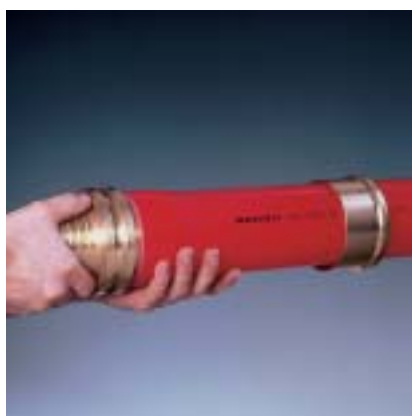
Fig. 18 4. Fitting in de buis steken. Na korte tijd zit de fitting vast in de buis.
