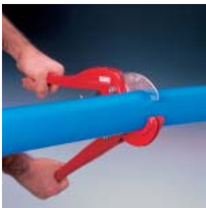
Fig. 27 1. Buis op de gewenste lengte inkorten.
