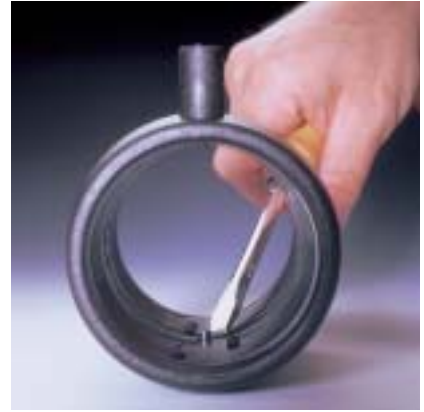
Fig. 64 Indien moffen moeten worden gebruikt als overschuifmof, moet de aanslagnippel worden verwijderd.
