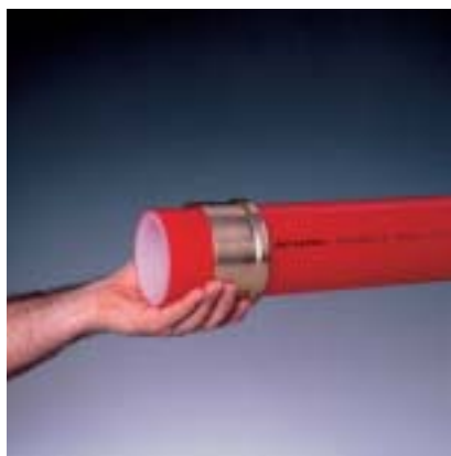
Fig. 16 2. Pershuls over de buis schuiven. De inwendige afschuining moet naar het uiteinde van de buis wijzen.
