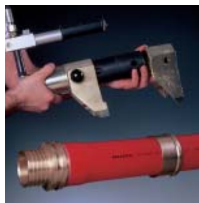
Fig. 20 6. Persbek op de cilinder plaatsen.
