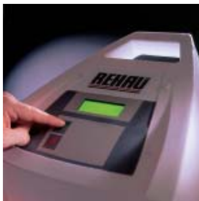
Fig. 36 10. Bedieningsknop van het lasapparaat indrukken.
