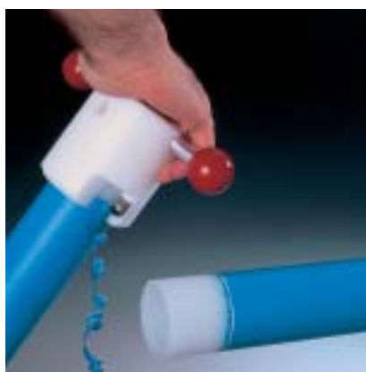
Fig. 30 4. Bij gebruik van een schilapparaat hoeft er niet te worden afgetekend.
