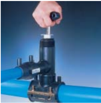
Fig. 48 9. Na de drukbeproeving met een inbussleutel NW 12 de gatenboor in de hoofdbuis schroeven.
