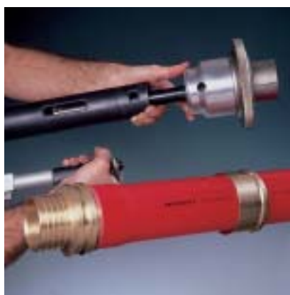
Fig. 19 5. De expandeereenheid van het gereedschap demonteren.
