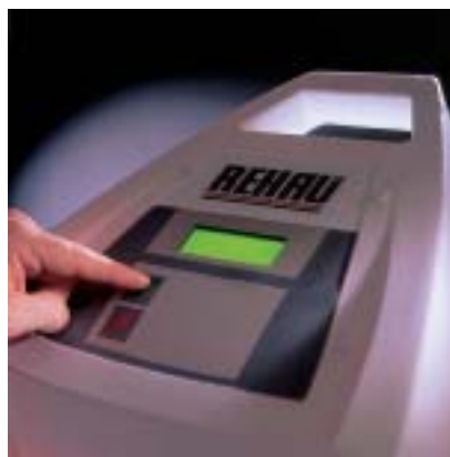
Fig. 45 6. Start het lassen door de startknop in te drukken.
