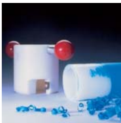
Fig. 57 Wanneer een schilapparaat wordt gebruikt, slechts eenmaal toepassen. Resten van de mantel op de buis verstoren het lassen niet, voor zover wel de bovenste laag is verwijderd.
