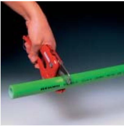
Fig. 7 1. Buis op de gewenste lengte inkorten.
